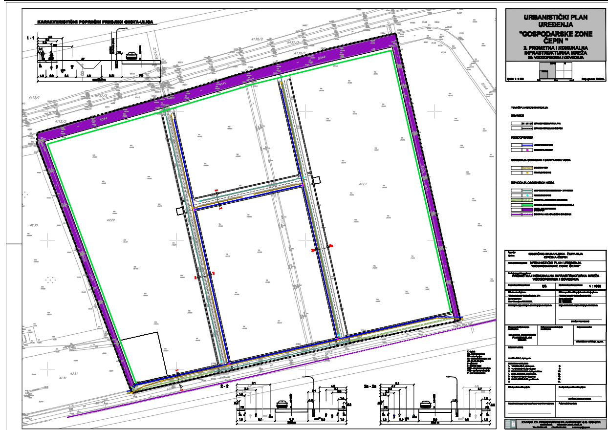
Slika 6. Izvod iz važećeg Urbanističkog plana uređenja Gospodarska zona Čepin – 2D. Prometna i komunalna infrastrukturna mreža – vodoopskrba i odvodnja
